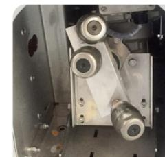
La presencia de las boquillas a nivel de los lava ruedas. asegura una precisa limpieza de las llantas.
